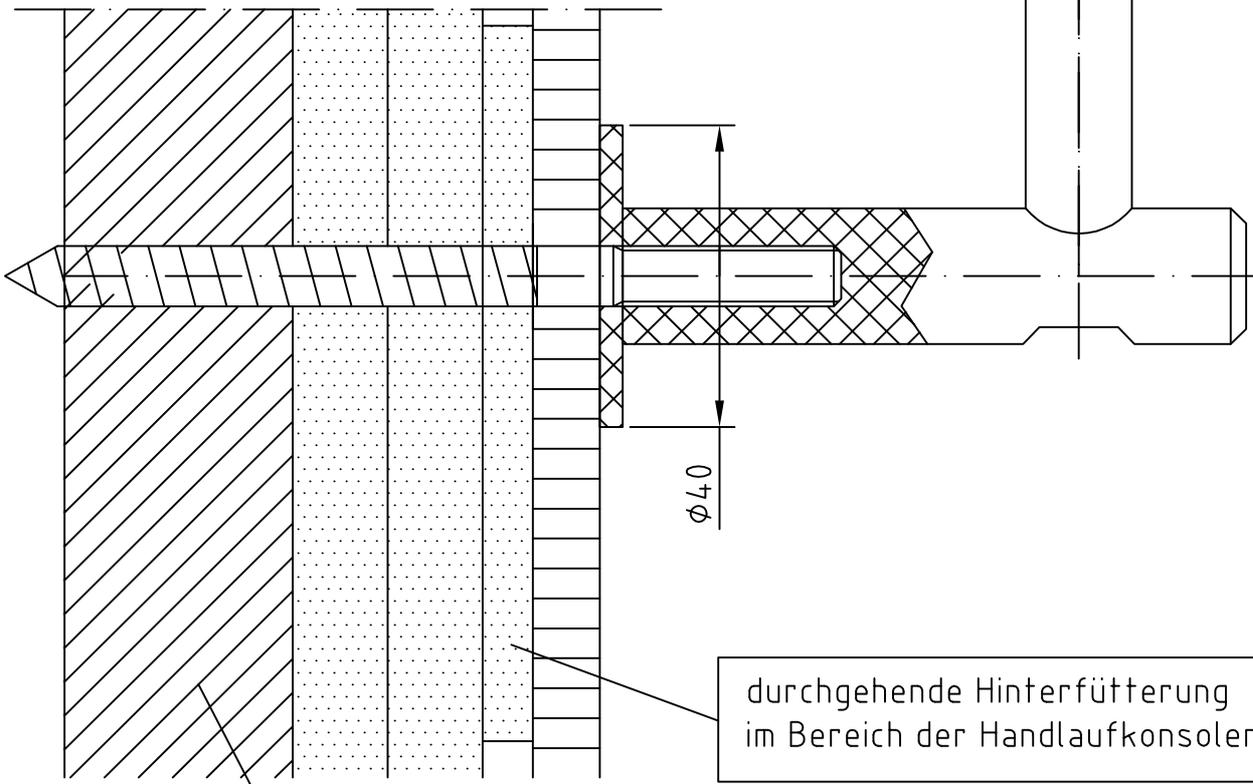
durchgehende Hinterfütterung im Bereich der Handlaufkonsolen
