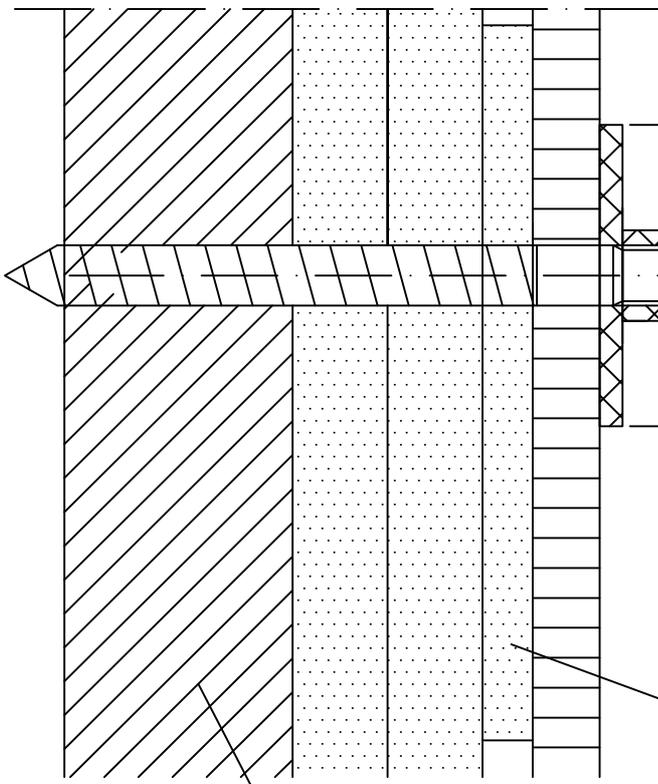
durchgehende Hinterfütterung im Bereich der Handlaufkonsolen
