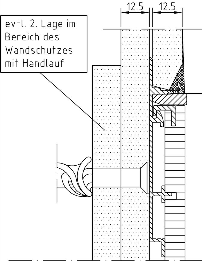
Zum Demontieren des Handlaufs, Madenschraube in Richtung Wand herausdrehen, dann Handlauf nach oben abnehmen
