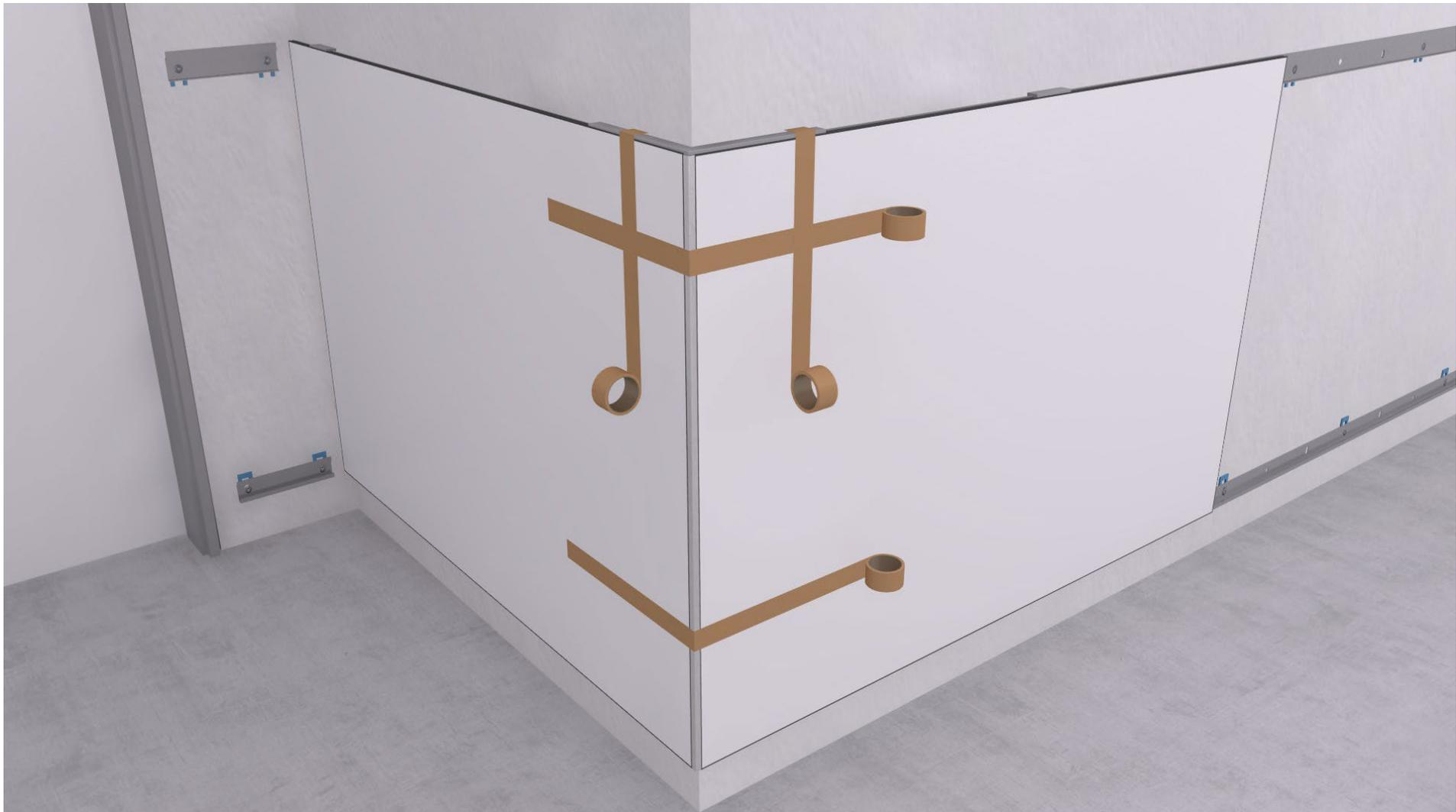
Verkleben Sie die Eckprofile mit dem mitgelieferten Hybridkleber. An der Innenflanke der Nut und zusätzlich punktuell am Eckprofil.
