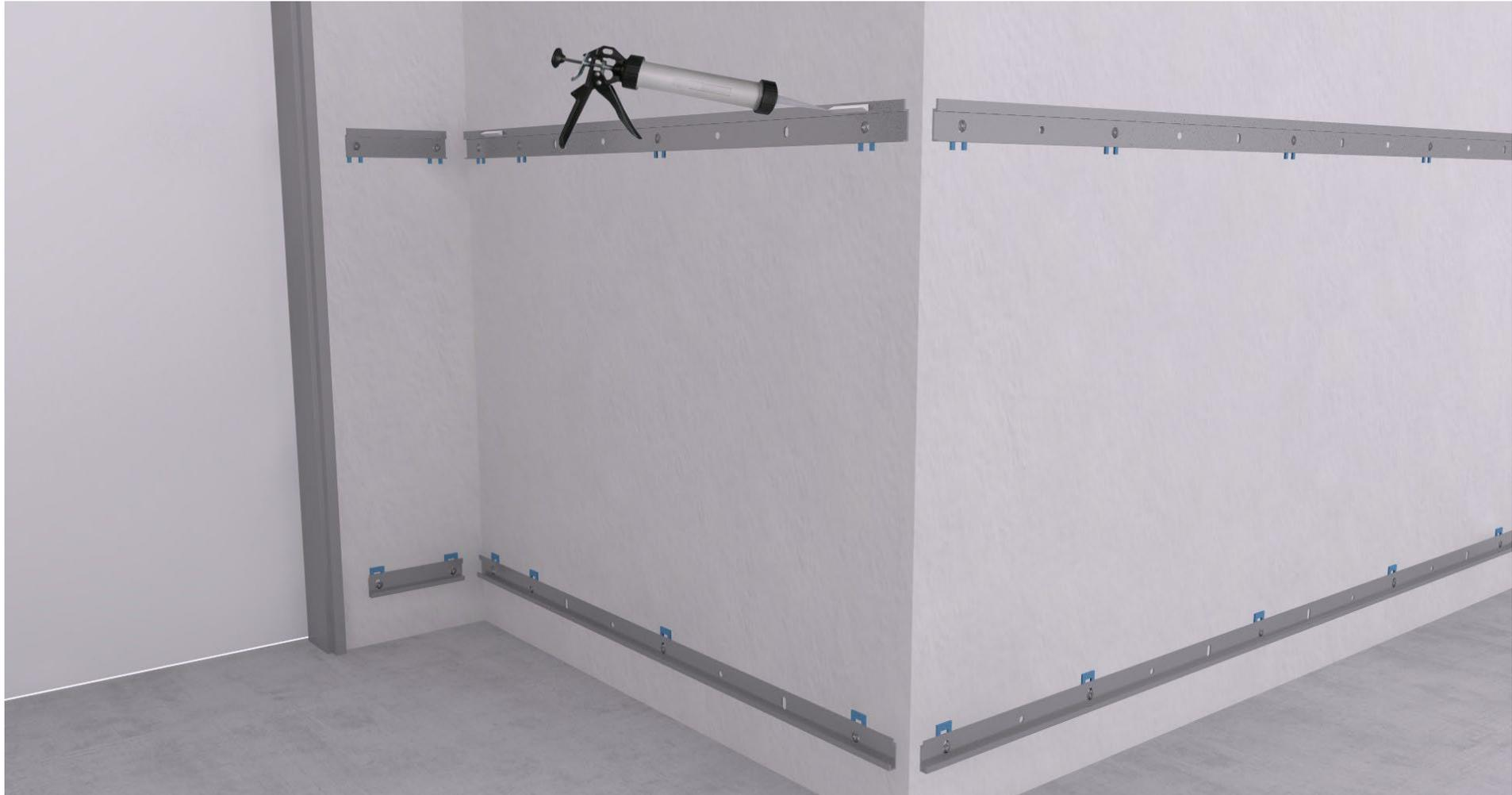
Ziehen Sie immer im Stoßbereich sowie am Anfang und Ende des Panels eine Silikonnaht. Diese muss nicht durchgehend sein!
