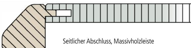
Seitlicher Abschluss, Massivholzleiste
